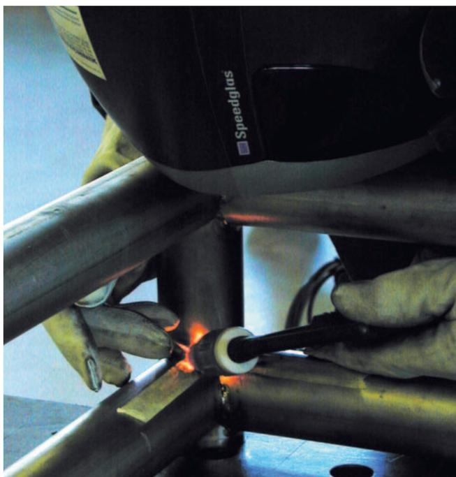
Abb. 3: Rohrkonstruktion aus Ti2 (INOX-Schweisstechnik Zug)
