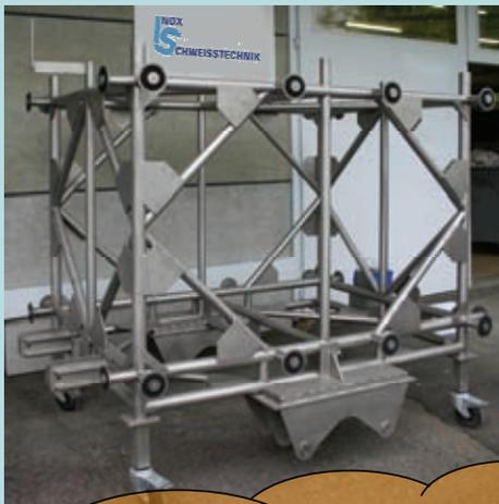
Natürlich kann so was (fast) Jeder. Ein paar Rohre, Knotenbleche, Versteifungen und Räder drunter. Unter Last (ca. 1T) darf sich die Konstruktion allerdings nicht mehr als 0,5 mm verziehen!
